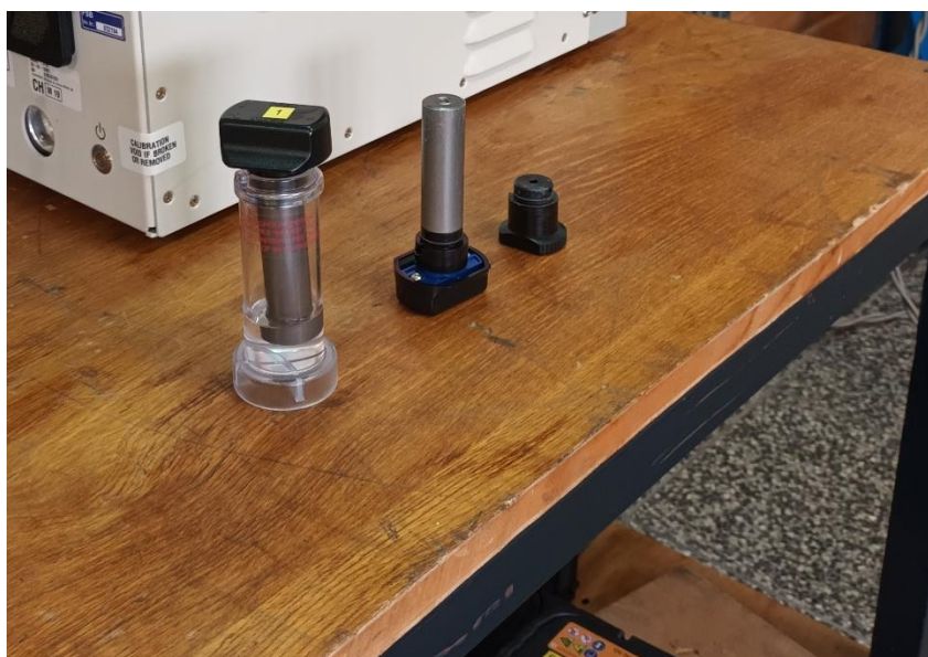
Slika 4.1. Natapanje umetka izopropilenom
