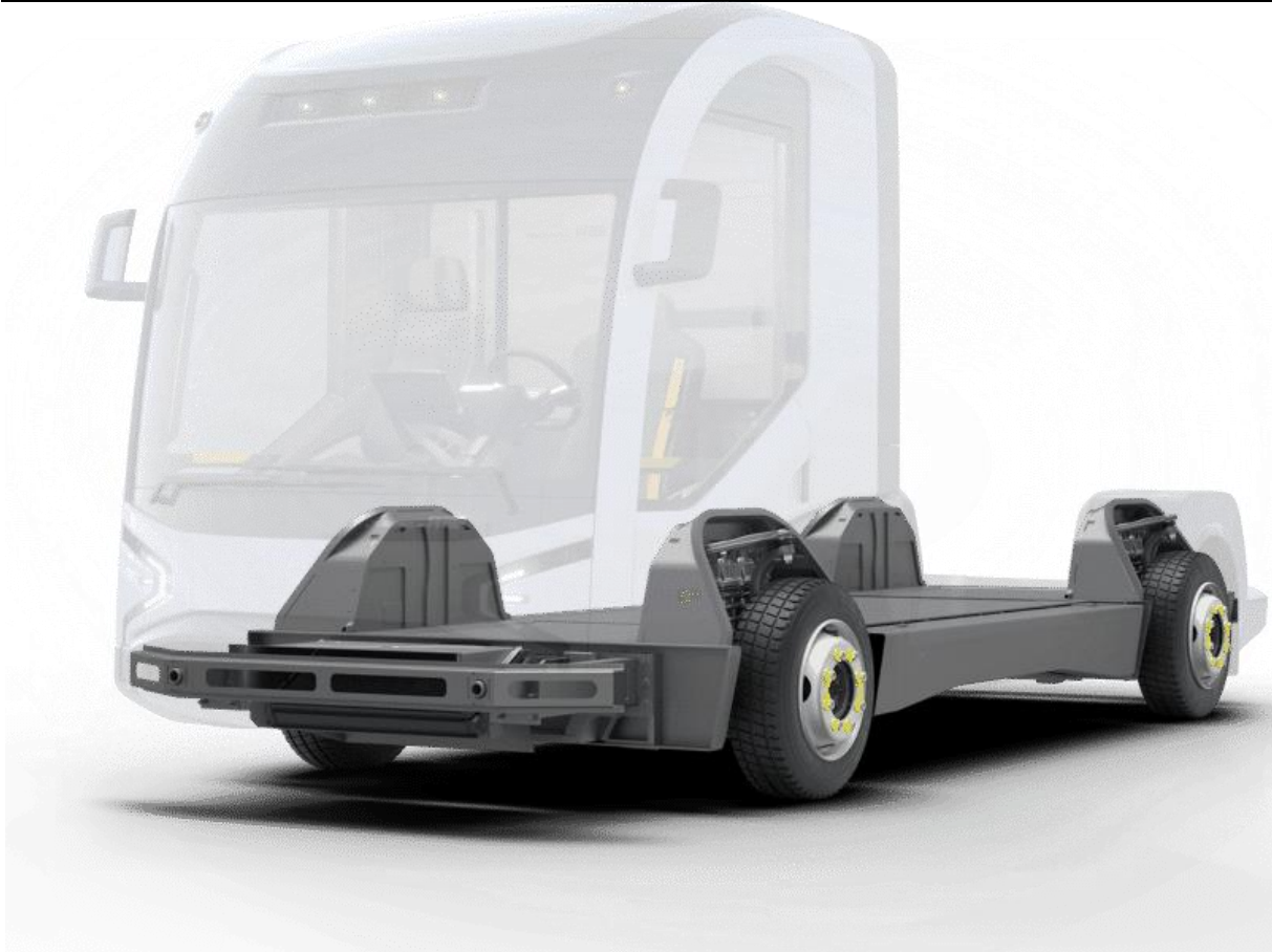
Slika 8. Prikaz šasije REE P7C [8]
