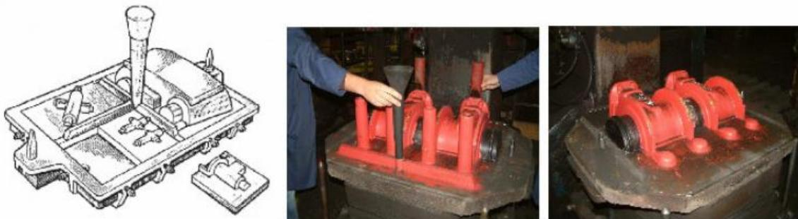
**Slika 5. Segmentna modelna ploča i jednodjelna ploča za donjak i gornjak [4]**
