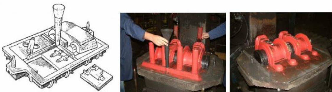
Slika 5. Segmentna modelna ploča i jednostrojna ploča za donjak i gornjak [4]
