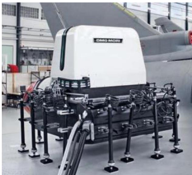
Slika 26. Hibridni obradni stroj Ultrasonic mobileBlock [23]
