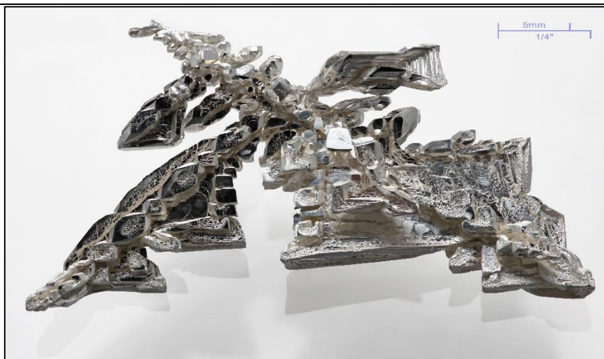
Slika 7 Čisti srebro dendritične građe [11]
