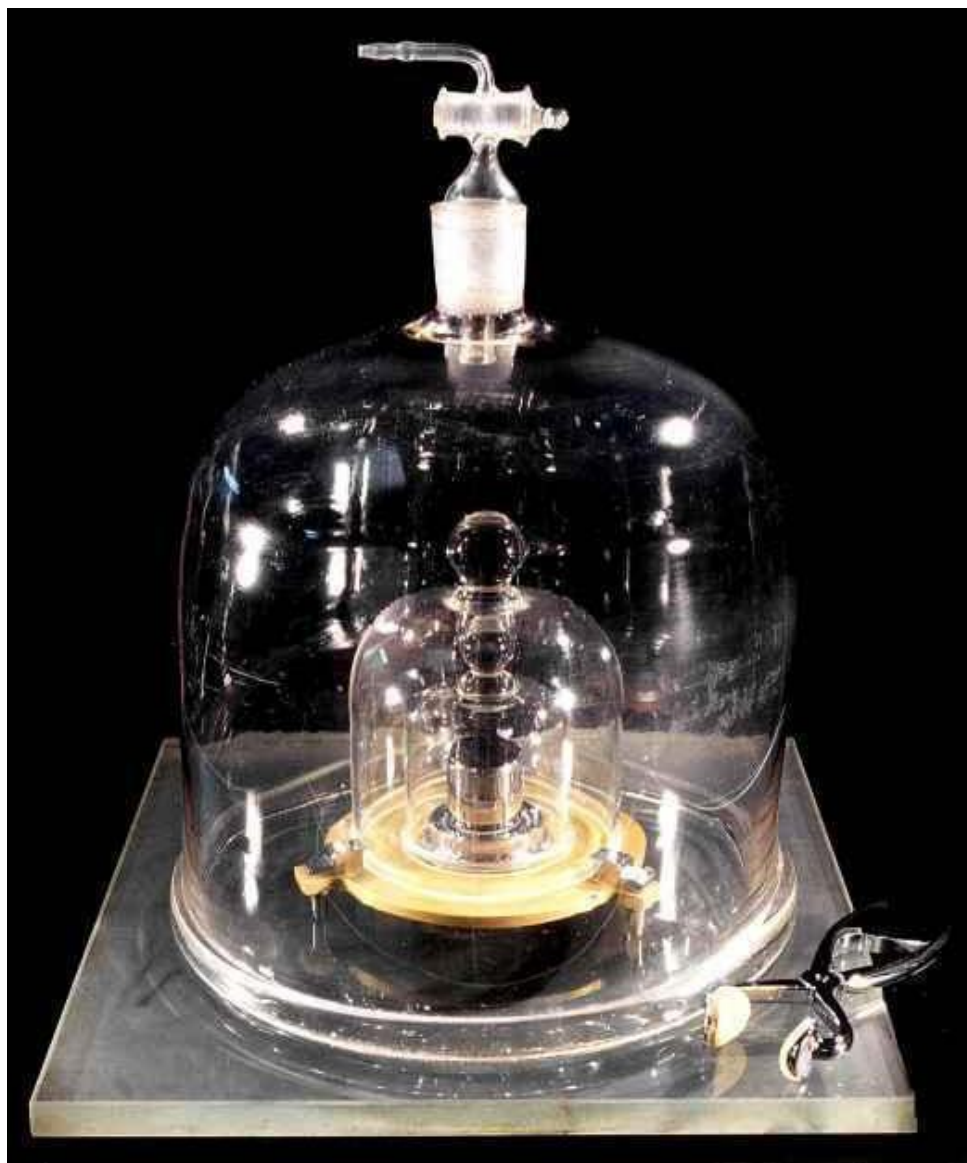
Slika 15 Međunarodni prototip kilograma [18]
