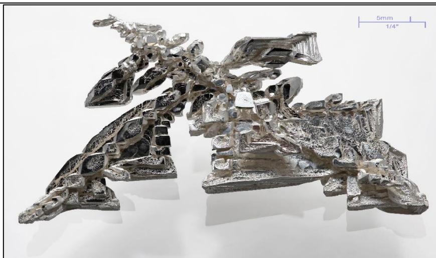
Slika 7 Čisti srebro dendritične građe [11]
