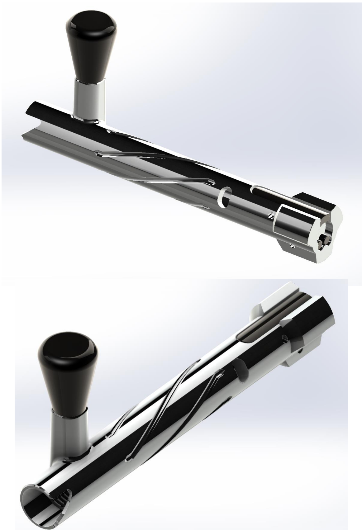
Slika 77. Realistični prikaz valjkastog zatvarača
