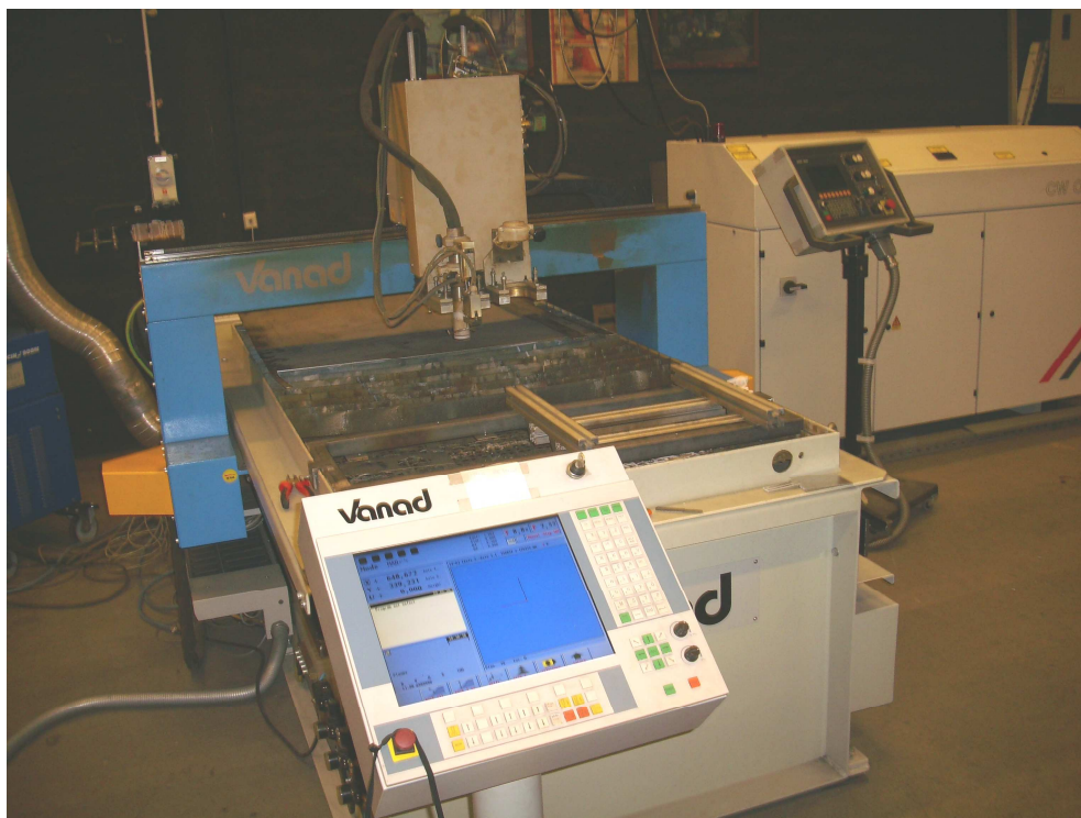
Slika 3.1. Prikaz CNC stola i upravljačke jedinice za plazma rezanje
