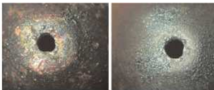
Slika 2.11. Oštećenje vanjskog dijela sapnice [11]
