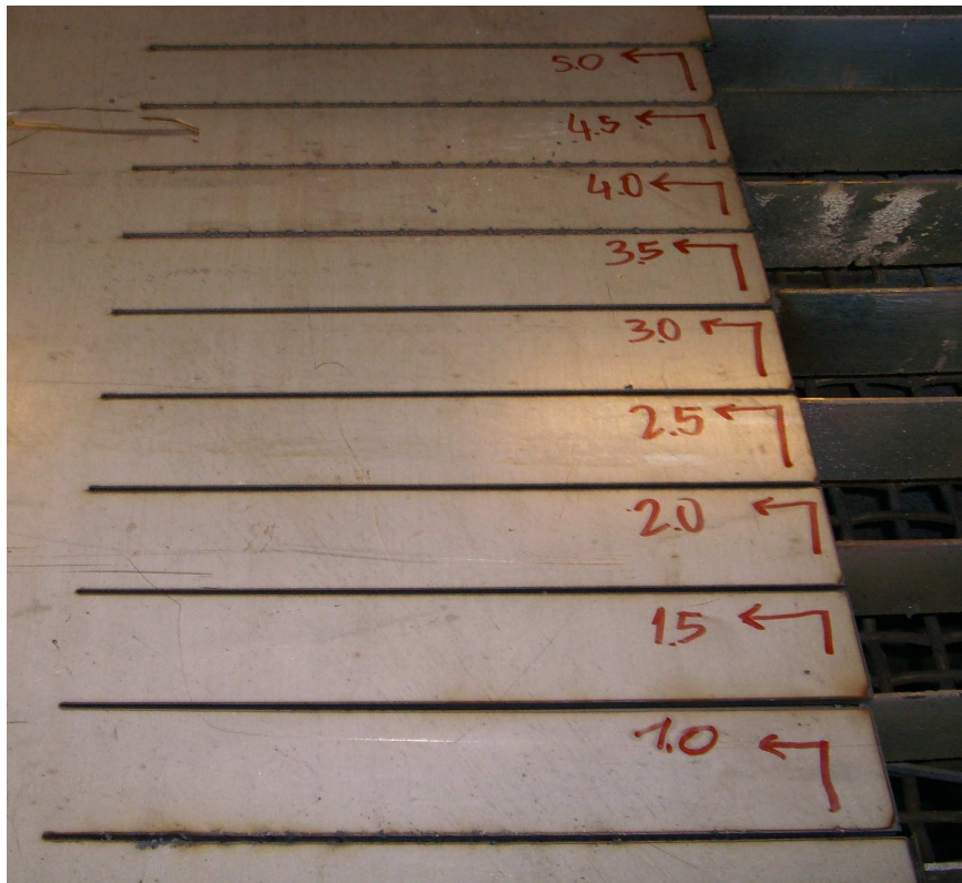
Slika 3.20. Uzorci nehrđajućeg čelika nakon rezanja – plazmeni plin zrak
