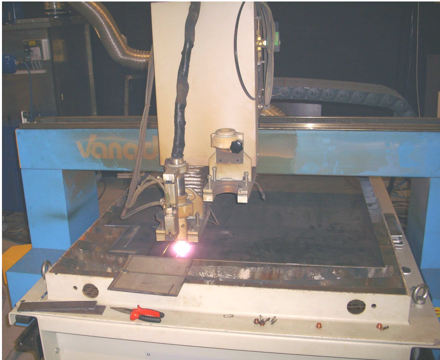
Slika 3.13. Plazma rezanje nelegiranog čelika – plazmeni plin kisik
