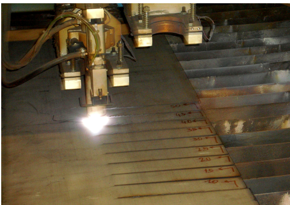
Slika 3.21. Odrezivanje uzoraka nehrđajućeg čelika – plazmeni plin zrak
