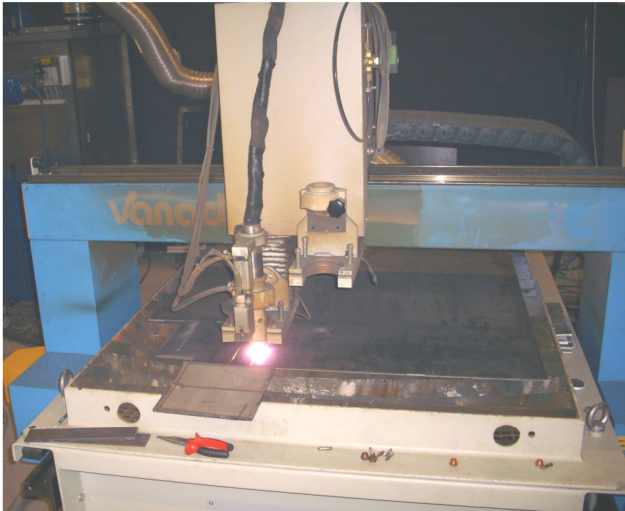
Slika 3.13. Plazma rezanje nelegiranog čelika – plazmeni plin kisik
