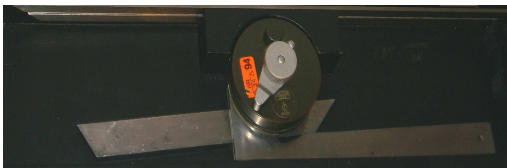
Slika 3.11. Kutomjer korišten za mjerenje tolerancije okomitosti ili kutnosti
