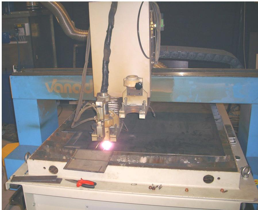
Slika 3.13. Plazma rezanje nelegiranog čelika – plazmeni plin kisik
