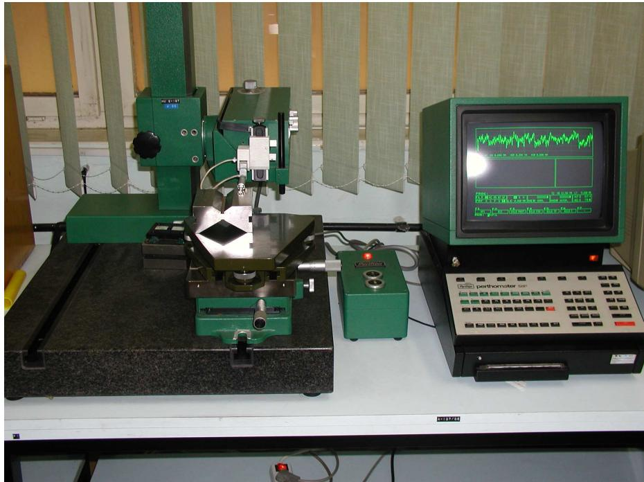
Slika 3.5. Prikaz uređaja za ispitivanje hrapavosti površine
