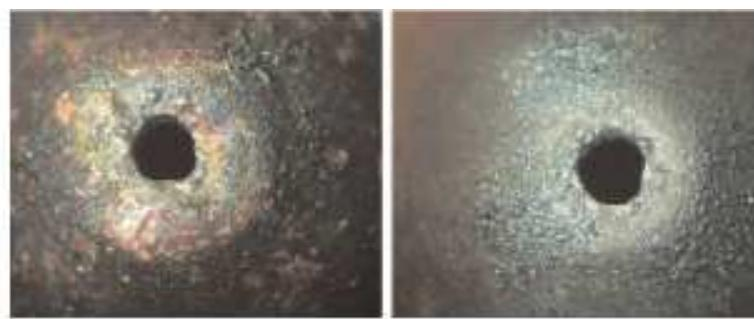
Slika 2.11. Oštećenje vanjskog dijela sapnice [11]
