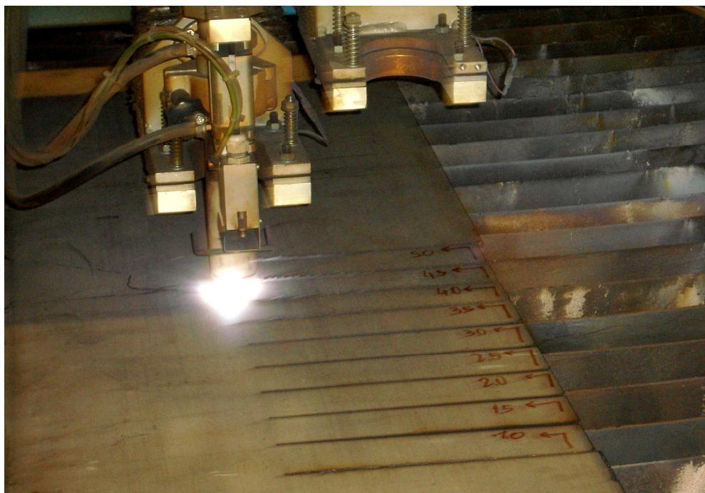
Slika 3.21. Odrezivanje uzorka nehrđajućeg čelika – plazmeni plin zrak
