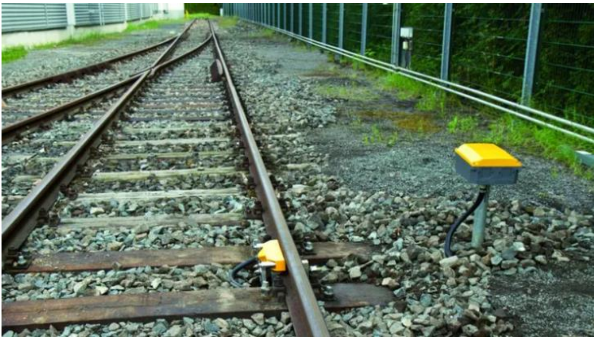
Slika 12. The Clearguard induktivni senzor
