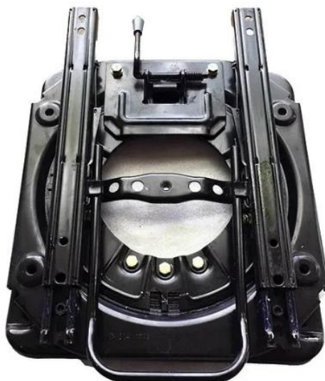
Slika 2. Okretni mehanizam u autima [7]
