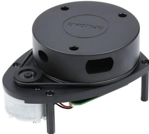
**Slika 13. Lidarski senzor *Slamtec RPLIDAR A1* [10]**
