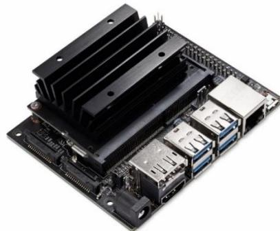
**Slika 11. Mikrokontroler Nvidia Jetson Nano Developer Kit-a [8]**
