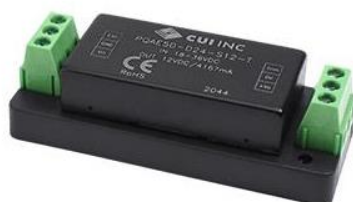
Slika 17. Regulator napona PQAE50-T [14]
