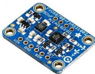
Slika 14. IMU-a Adafruit Precision NXP 9-DOF senzor [11]
