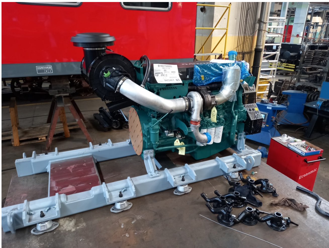
Slika 4. Nosač sa montiranim dizel motorom i elastičnim nosačima
