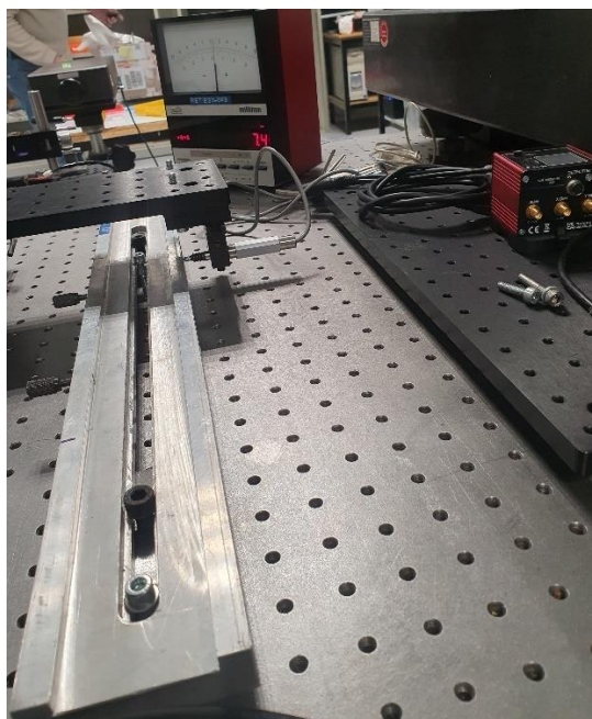
Slika 7. Mjerni sustav Tehnike preokreta u početnom položaju
