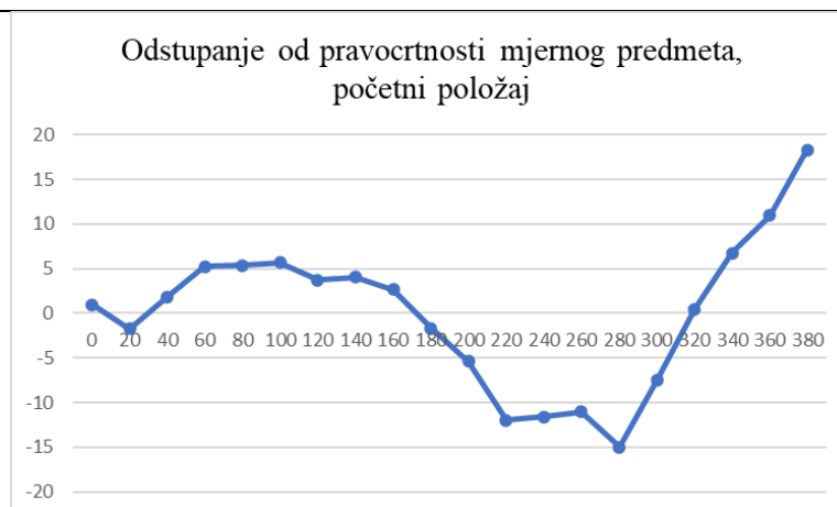
Slika 17. Odstupanje od pravocrtnosti mjernog predmeta, početni položaj
