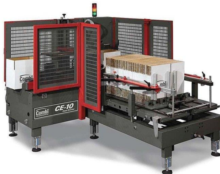
Slika 41. Uređaj za formiranje kutija – Combi CE-10
