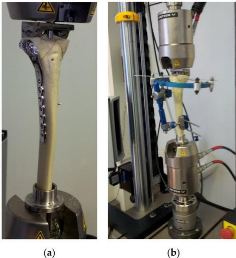
Slika 5.7. Ispitni sklop - a)PLS i b) HEF [14]
