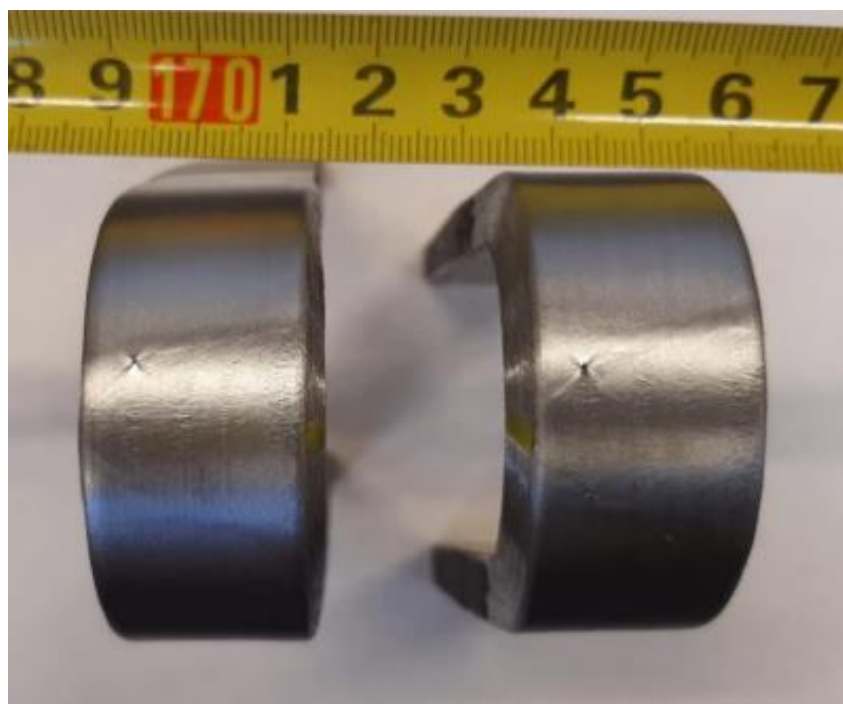
Slika 22. Uzorci nakon ispitivanja bočnog savijanja [21]
