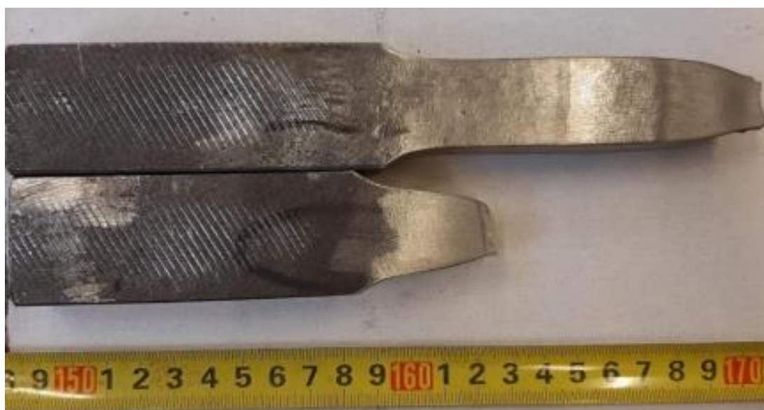
Slika 20. Uzorak epruvete nakon statičnog vlačnog ispitivanja [21]
