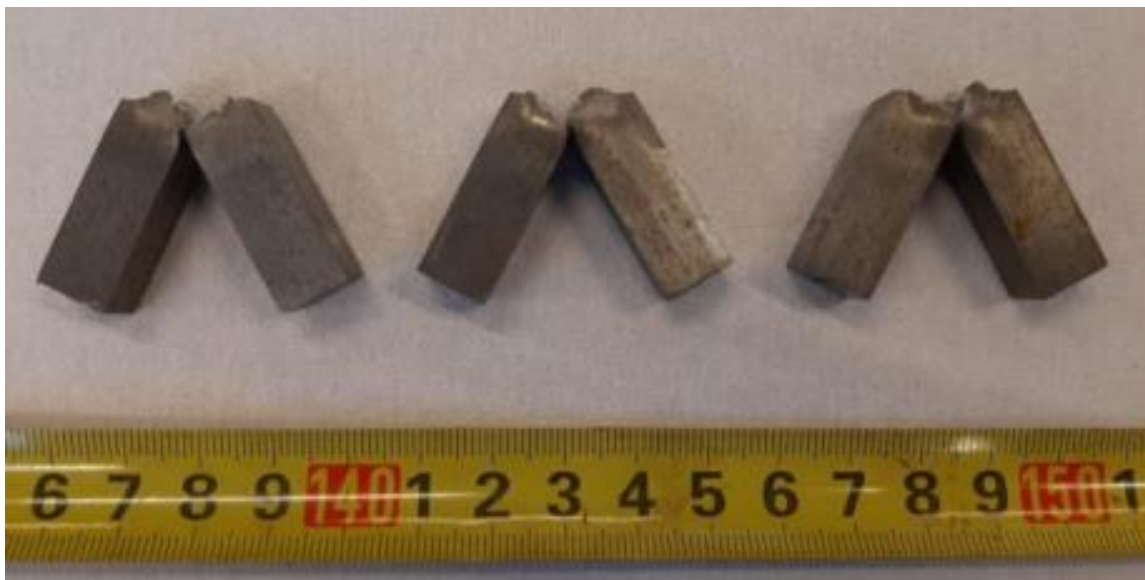
Slika 21. Uzorci nakon ispitivanja žilavosti metala zavara [21]
