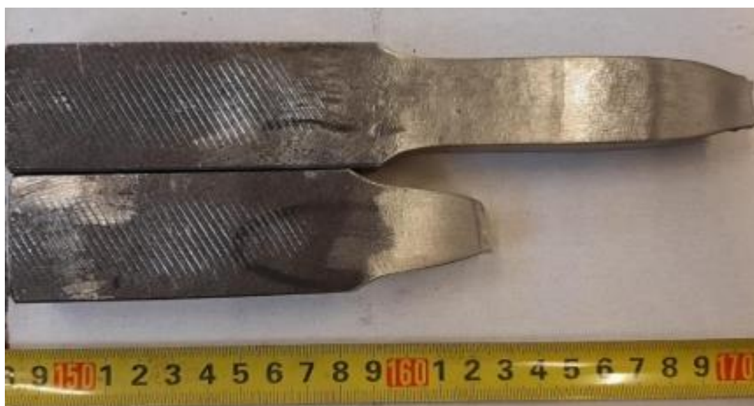
Slika 20. Uzorak epruvete nakon statičnog vlačnog ispitivanja [21]
