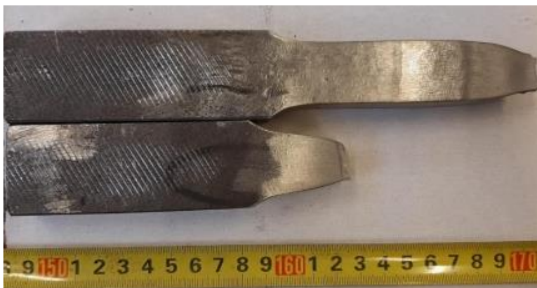
Slika 20. Uzorak epruvete nakon statičnog vlačnog ispitivanja [21]
