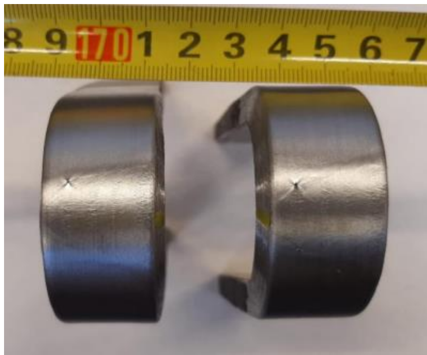
Slika 22. Uzorci nakon ispitivanja bočnog savijanja [21]
