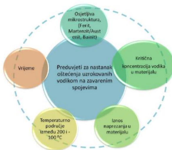
Slika 4. Preduvjeti za nastanak oštećenja uzrokovanih djelovanjem m mehanizma vodika [7]
