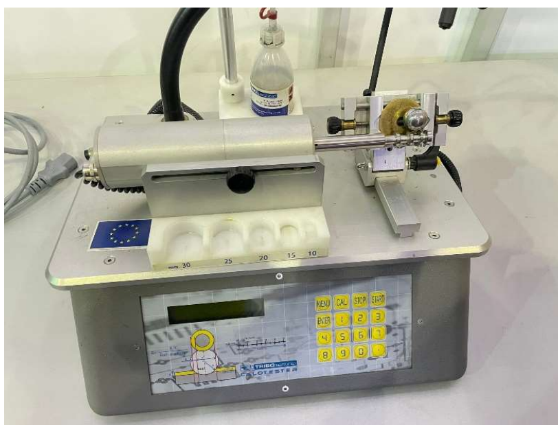
Slika 25: Kalotester TRIBOtechnic korišten za određivanje mikroabrazijskog trošenja TiN
