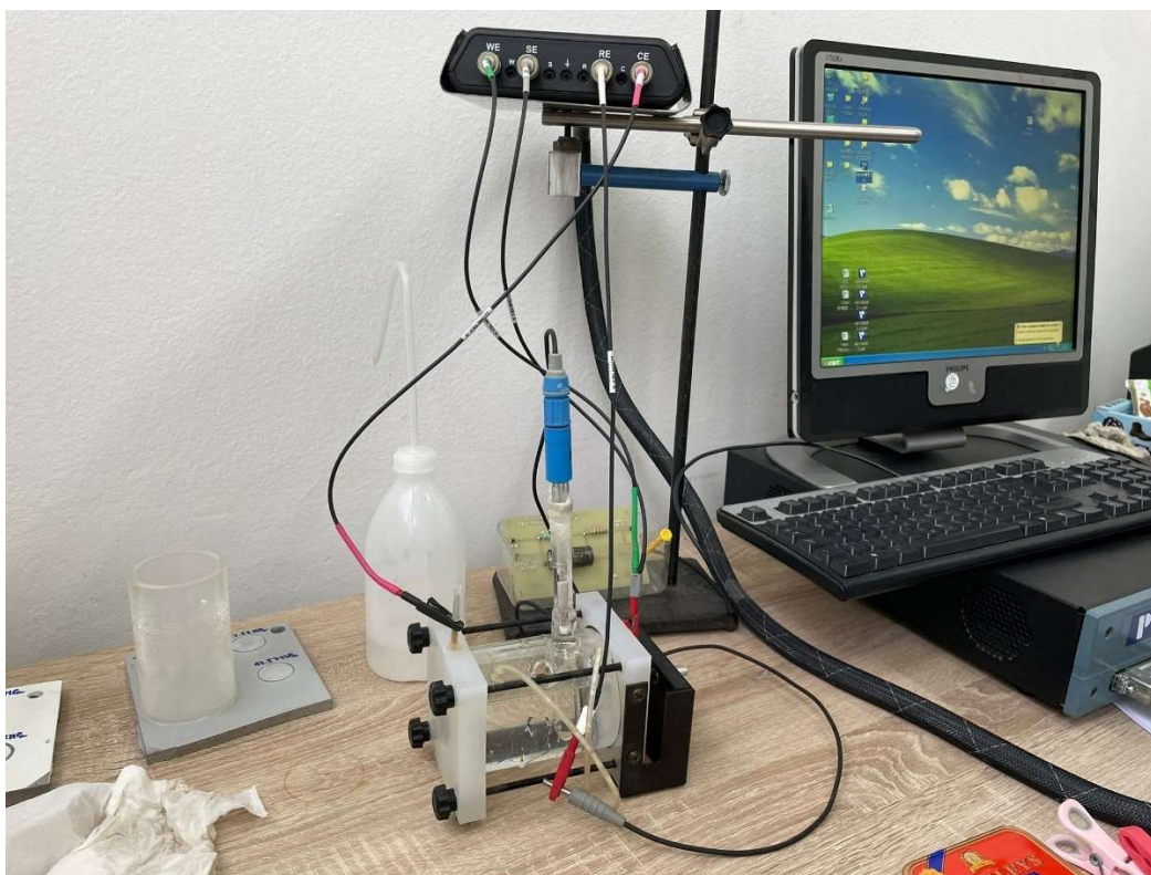
Slika 49: Ispitni uzorak uronjen u elektrolit i ispitivan u elektrokemijskoj ćeliji
