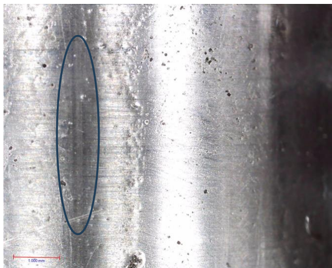
Slika 34. Površina neprevučenog prstena P0 od čelika 100Cr6 nako n30 min trošenja
