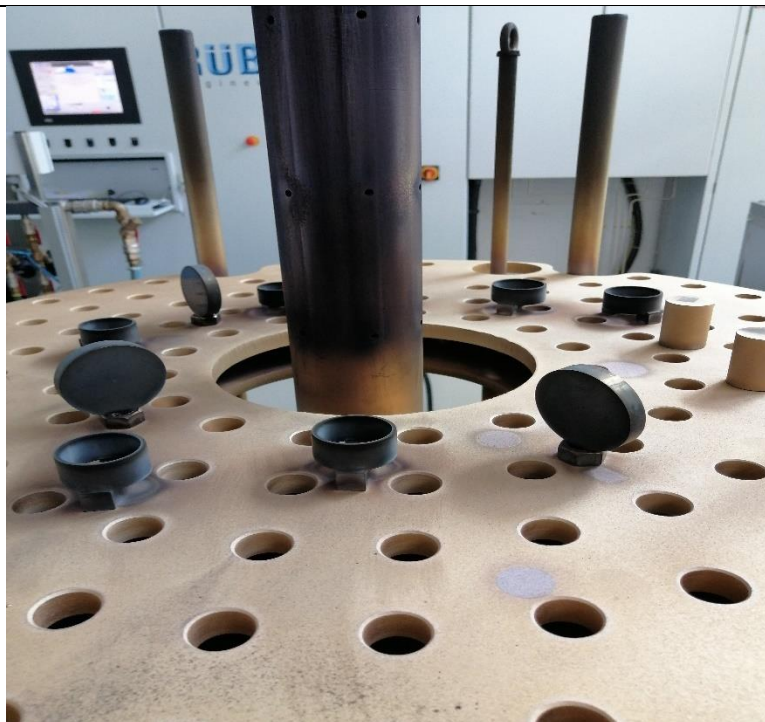
Slika 24. Prstenovi nakon nitiranja u plazmi
