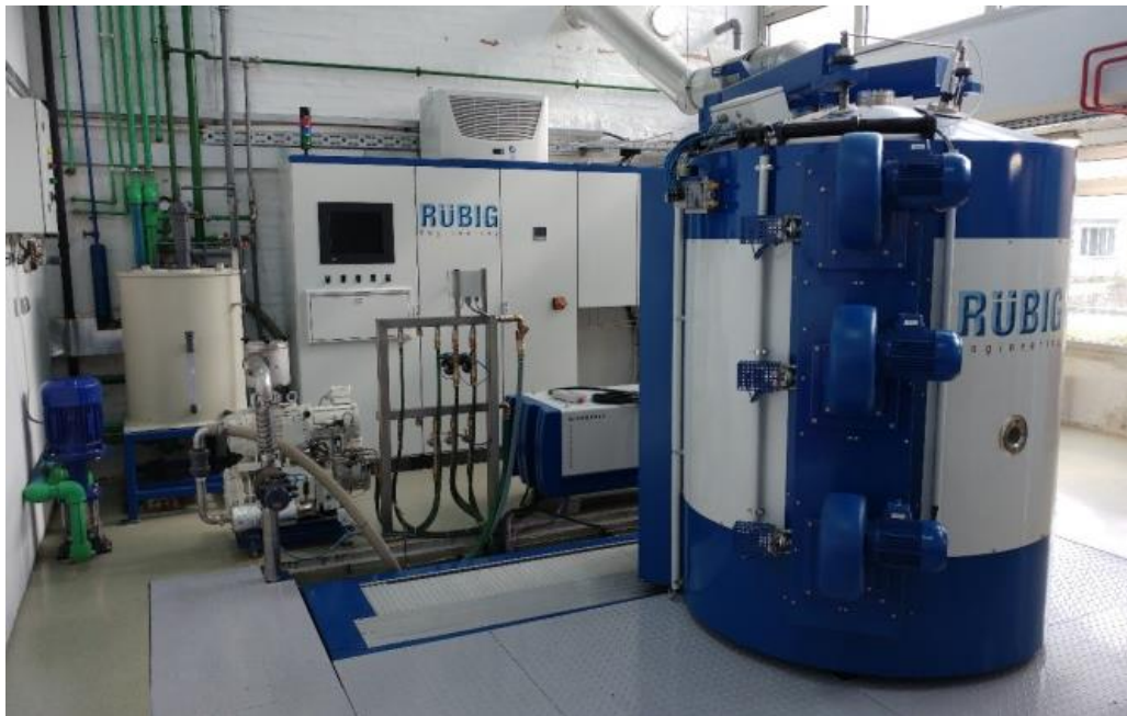
Slika 22. Vakuumska peć za nitriranje u plazmi Rübige PN 70/90
