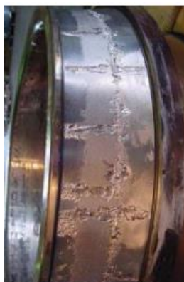
Slika 8. Oštećenja nastala tijekom rada ležaja: umor površine i adhezijsko trošenje [7]
