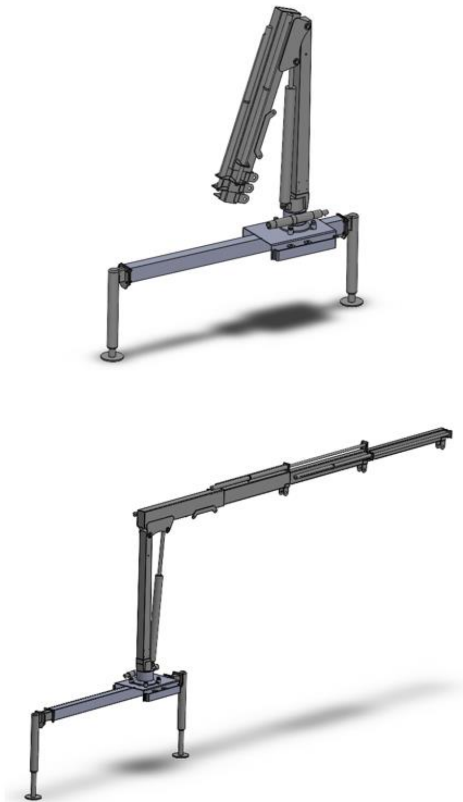
Slika 44. Model odabrane kranske dizalice
