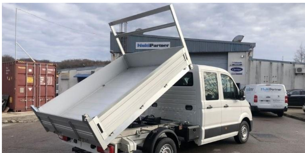
Slika 4. Otvoreni sanduk od aluminijskih legura
