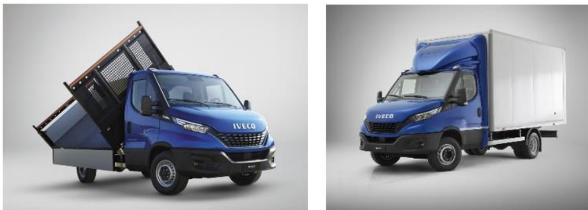
Slika 3. Primjeri nadogradnji vozila kategorije N1 [3]
