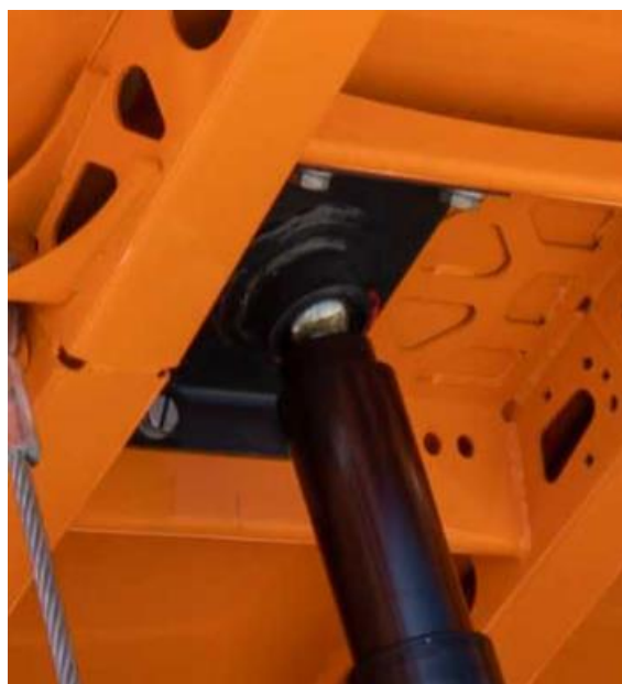
Slika 33. Primjer prihвата hidrauličnog cilindra na tovarni sanduk [10]
