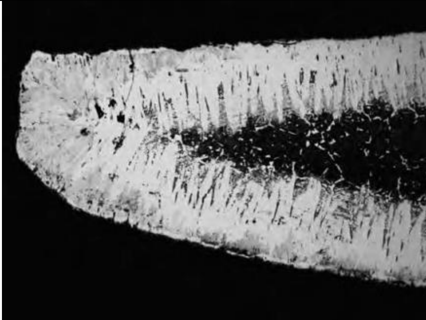
Slika 6. Nastanak FeB faze na vrhu oštrice alata [9]
