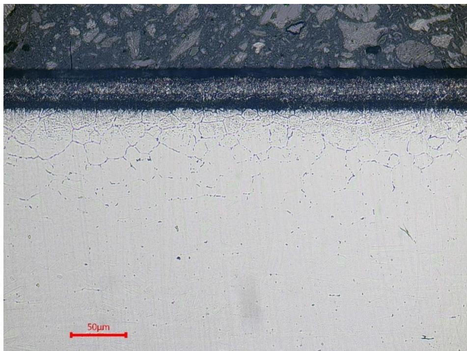
**Slika 36. Mikrostruktura boridnog sloja na uzorku B31**
