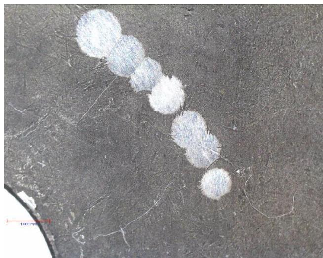
**Slika 43. Uzorak B41 trošen 10-90 s**
