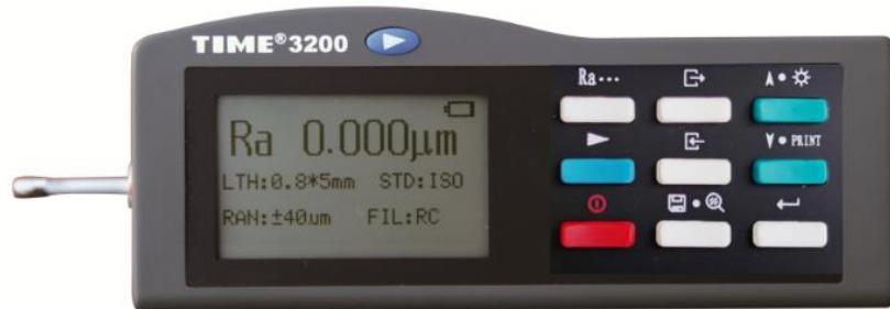
**Slika 32. Uređaj za mjerjenje hrapavosti TIME 3202**
