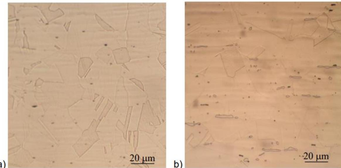
**Slika 1. Mikrostruktura austenitnog nehrđajućeg čelika:
