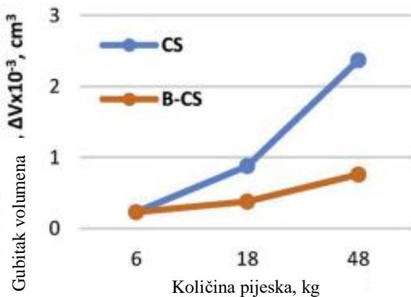
Slika 13. Erozijsko ispitivanje neobradjenog i boriranog C22 čelika [16]
