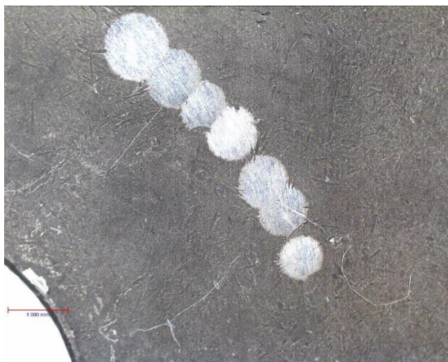
Slika 43. Uzorak B41 trošen 10-90 s
