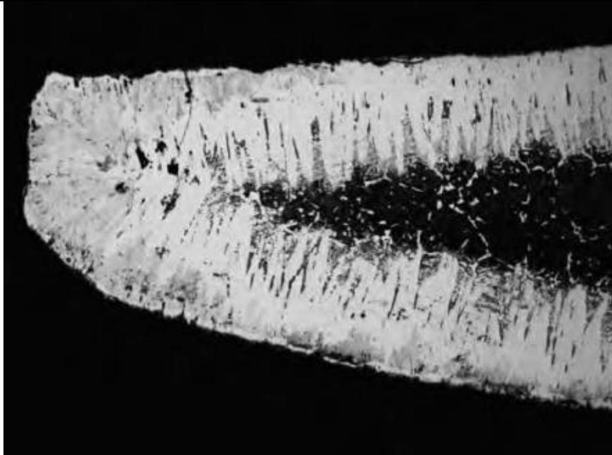
Slika 6. Nastanak FeB faze na vrhu oštice alata [9]
