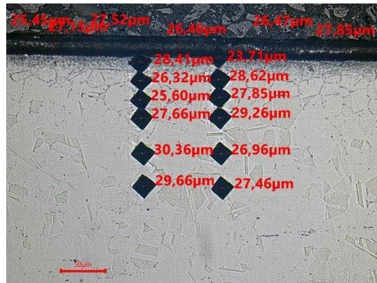
**Slika 30. Otisci nastali mjerjenjem mikrotvrdoće po dubini na boriranom uzorku B21**
