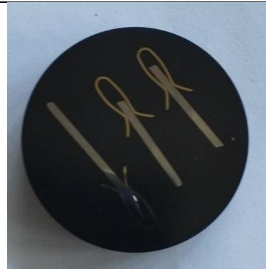
**Slika 34. Uzorci boriranog čelika X5CrNiMo17-12-2 pripremljeni za metalografsku analizu**
