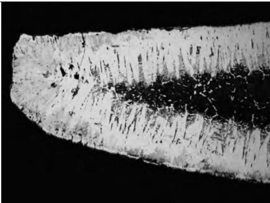
Slika 6. Nastanak FeB faze na vrhu oštrice alata [9]
