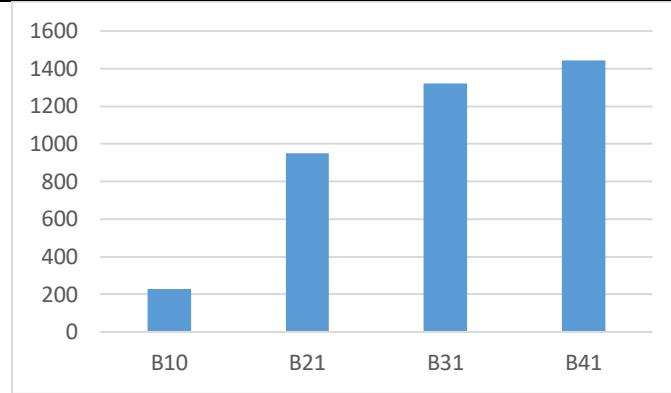
**Slika 29. Tvrdoča površine boriranih uzoraka od čelika X5CrNiMo17-12-2**
