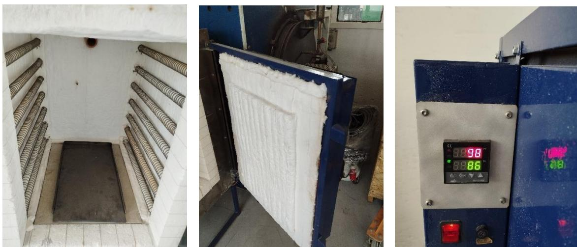
**Slika 24. Elektrootporna peć s automatskom regulacijom temperature**
