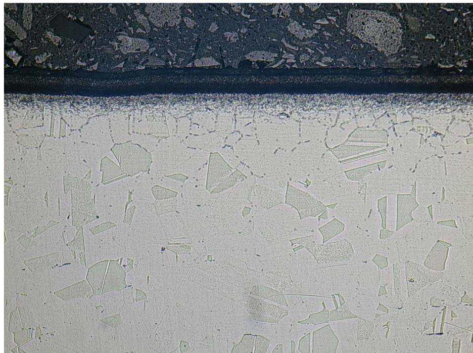
**Slika 35. Mikrostruktura boridnog sloja na uzorku B21**
