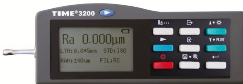
Slika 32. Uređaj za mjerenje hrapavosti TIME 3202
