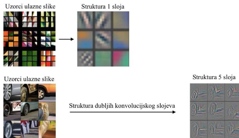
Slika 60. Detekcija značajki filtera po slojevima[43]
