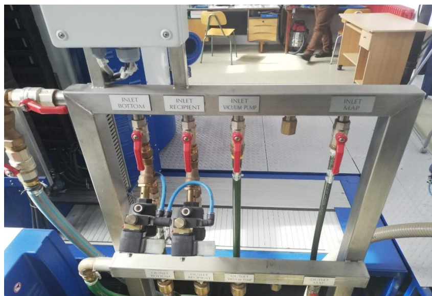
Slika 2.2 Razvod plinova za vakuumsku peć Rübig PC 70/90
