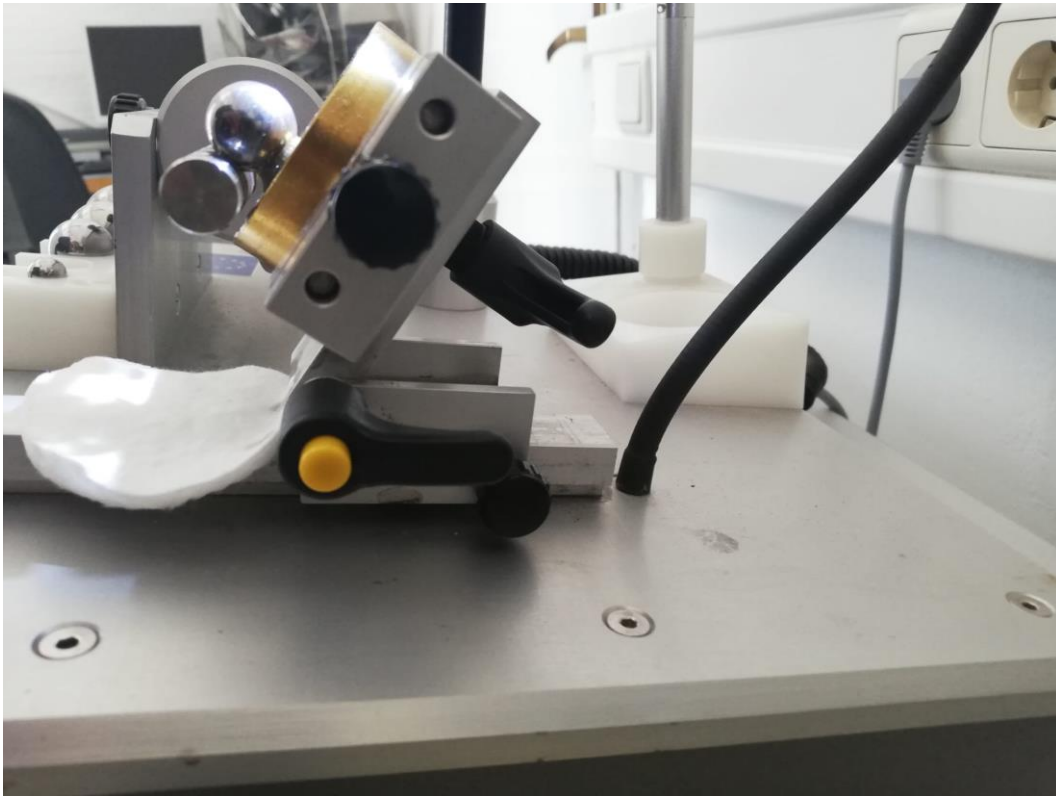
Slika 5.5 Ispitivanje debljine prevlake slobodno rotirajućom kuglom
