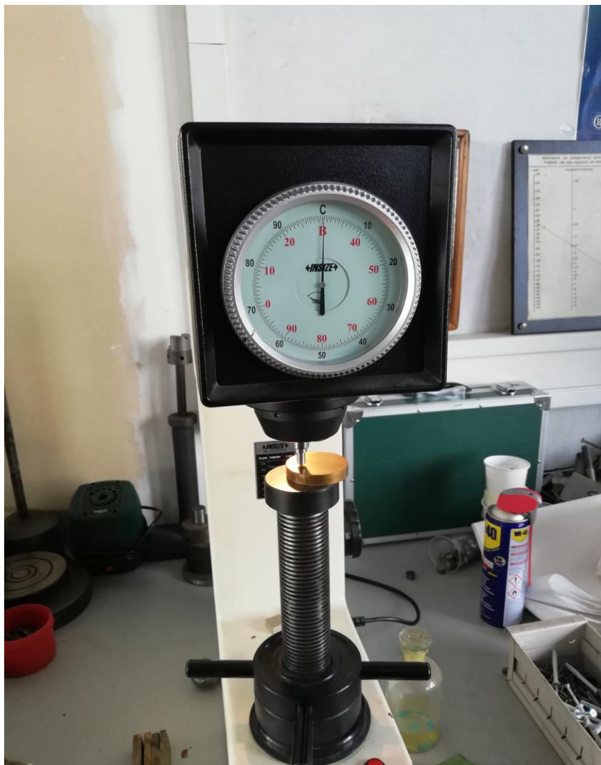
Slika 5.1 INSIZE uređaj za ispitivanje tvrdoće
