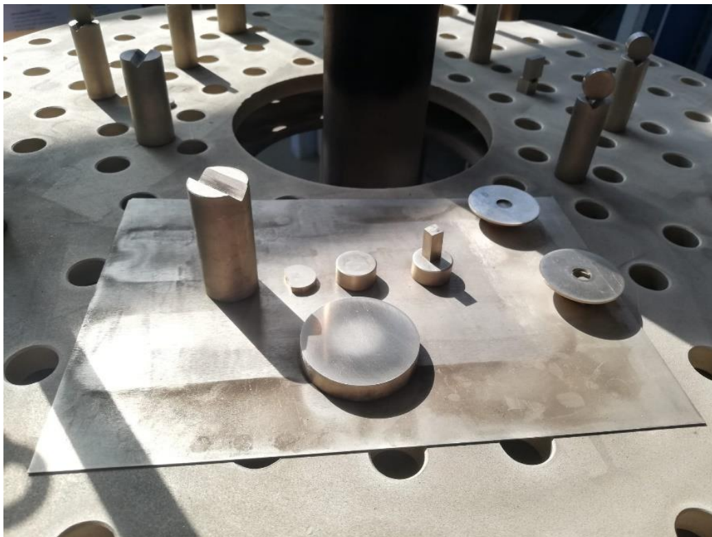
Slika 4.3 Položaj uzoraka u napravi za šaržiranje
