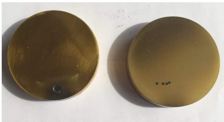
Slika 4.1 Prevučeni uzorci od čelika 100Cr6
