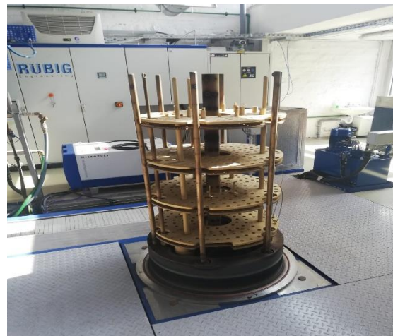
Slika 2.3 Komora peći Rübig PC 70/90 za postupak PACVD: a) vanjski izgled postrojenja, b) naprava za šaržiranje
