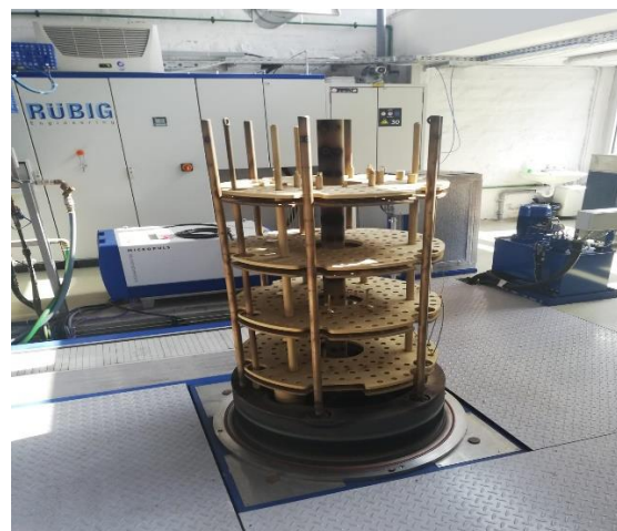
Slika 2.3 Komora peći Rübiger PC 70/90 za postupak PACVD: a) vanjski izgled postrojenja, b) naprava za šaržiranje
