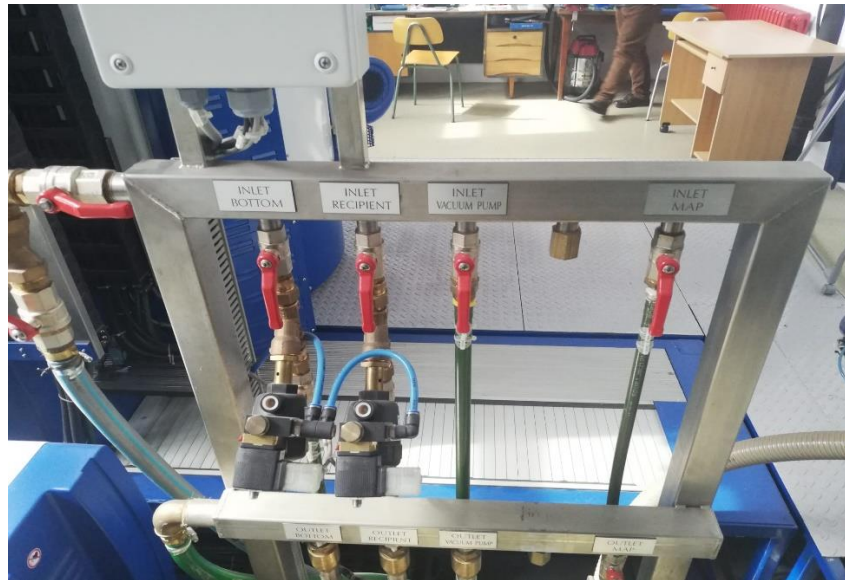
Slika 2.2 Razvod plinova za vakuumsku peć Rübig PC 70/90
