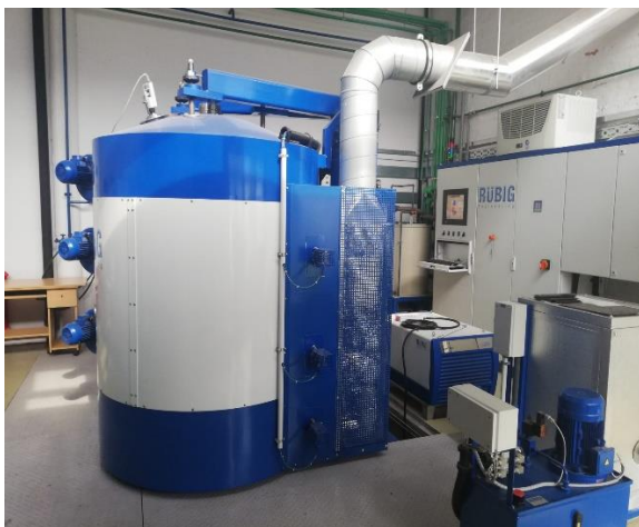
Slika 2.3 Komora peći Rübig PC 70/90 za postupak PACVD: a) vanjski izgled postrojenja, b) naprava za šaržiranje
