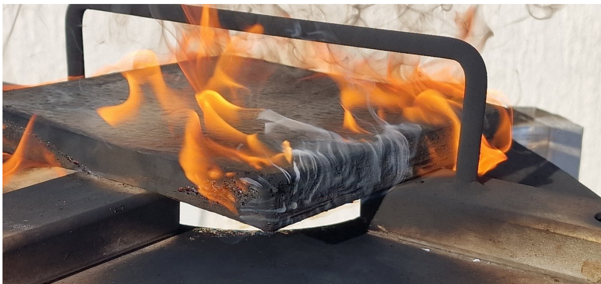
Slika 16. Zapaljenje uzorka U2
