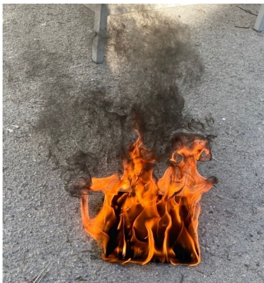
Slika 15. Uzorak U1 nakon sklanjanja sa plamena
