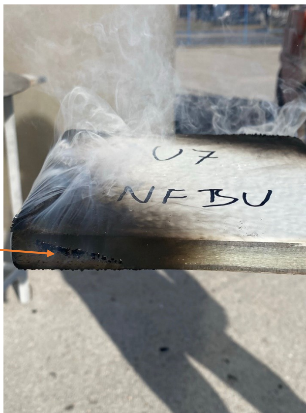
Slika 25. Zapaljenje bočnih stranica uzorka U7
