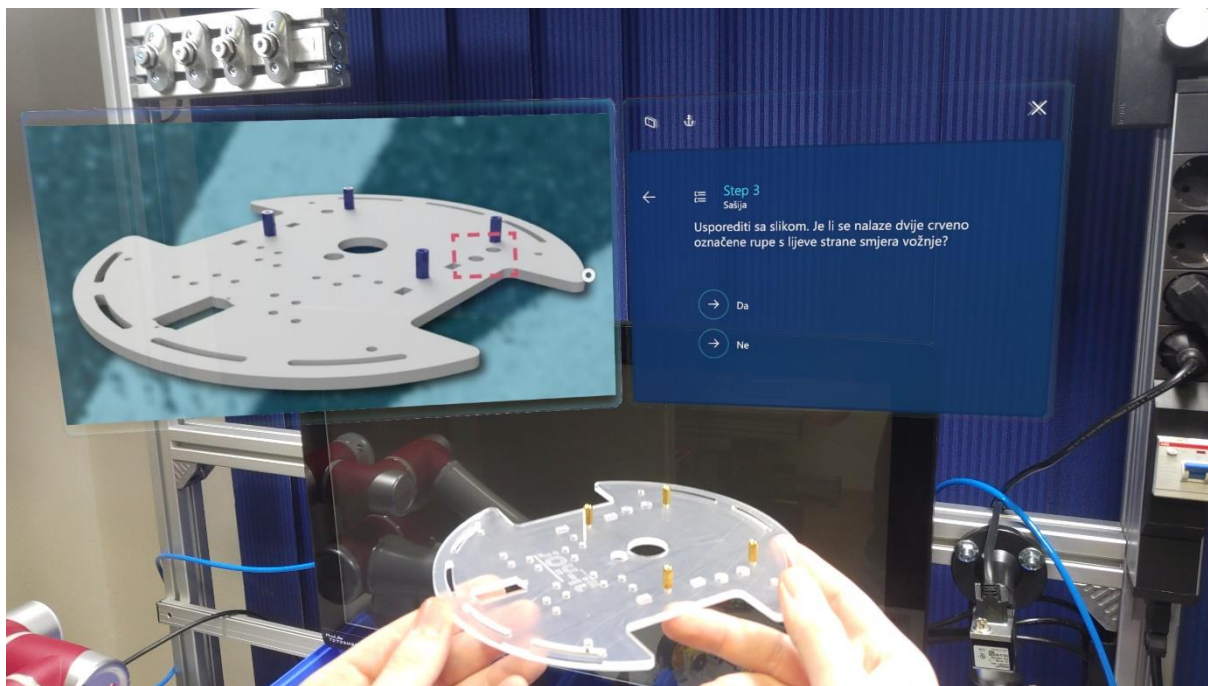
Slika 18. Provjera kvalitete montaže na samom izvoru
