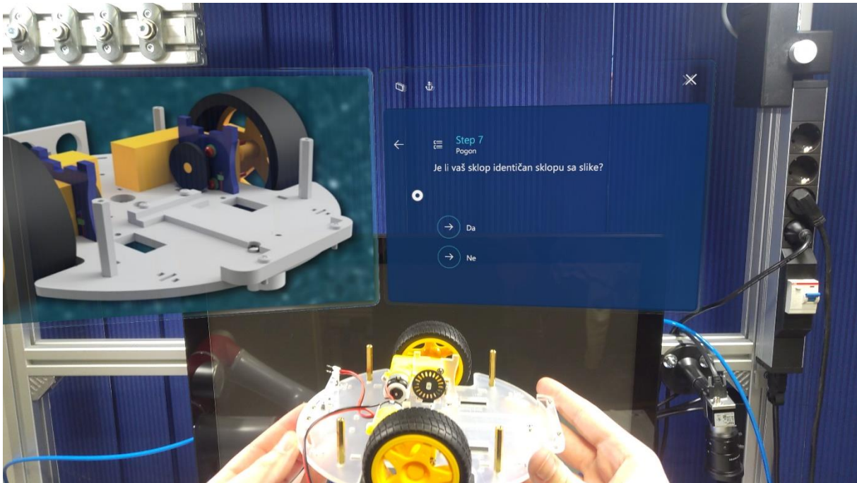
Slika 16. Provjera ispravnosti montaže
