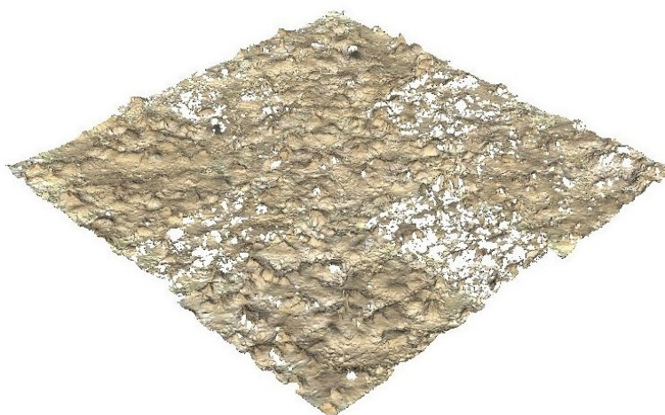
Slika 34. Prikaz nepotpuno skenirane površine brusnog papira (skenirano pomoću AS)
