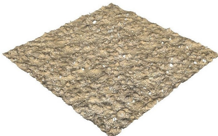
Slika 33. Prikaz skenirane površine brusnog papira bez rupa (skenirano pomoću AP)
