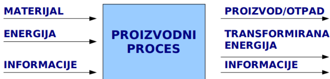
Slika 1. Shematski prikaz čimbenika proizvodnog procesa [1]
