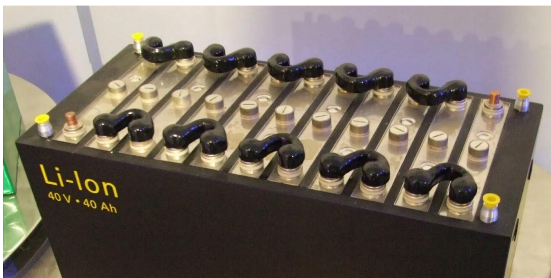
Slika 6. Baterijski sklop (eng. battery pack ) [14]
