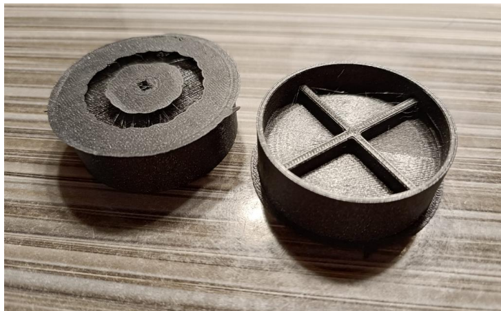
Slika 29. Par običnih kotača neposredno nakon 3D printanja
