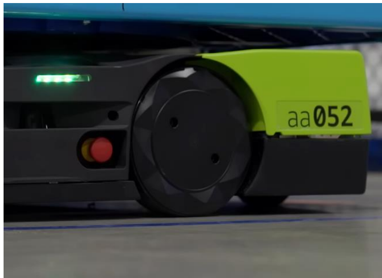
Slika 5. Kotač 'Proteus' robota
