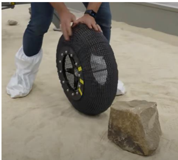
Slika 23. Kotač razvijen za kretanje po Mjesecu
