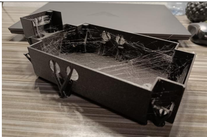
Slika 42. Kućište neposredno nakon printanja
