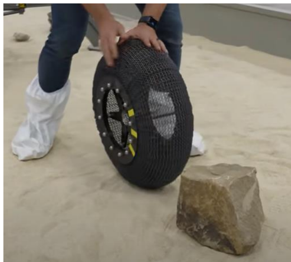
Slika 23. Kotač razvijen za kretanje po Mjesecu
