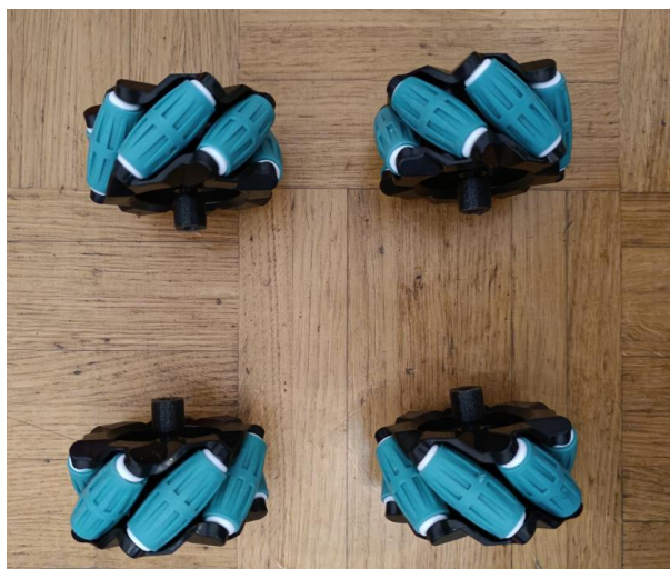
Slika 27. 'Mechanuum wheel' kotači – konačan izgled
