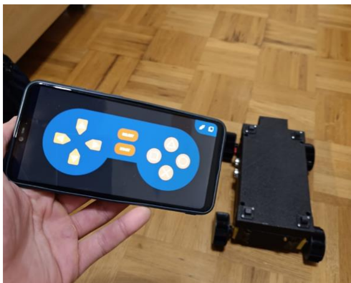
Slika 82. Ispitivanje rada Bluetooth komunikacije
