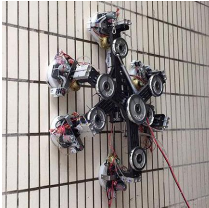
Slika 19. Hexapodni robot pomoću ZPD metode
