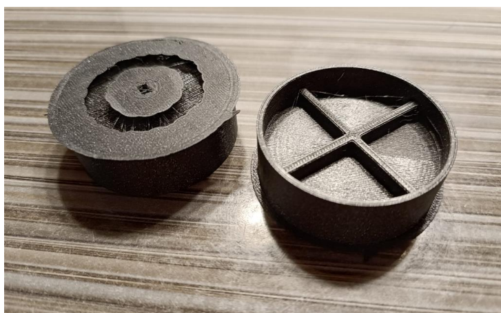
Slika 29. Par običnih kotača neposredno nakon 3D printanja
