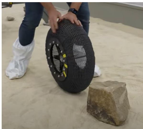
Slika 23. Kotač razvijen za kretanje po Mjesecu
