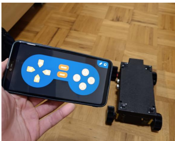
Slika 82. Ispitivanje rada Bluetooth komunikacije
