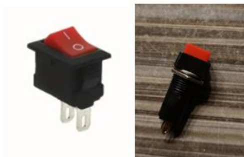
Slika 71. Sigurnosna sklopka i tipkalo
