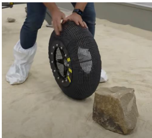
Slika 23. Kotač razvijen za kretanje po Mjesecu
