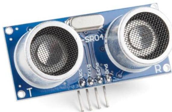
**Slika 46.** HCSR04**Tablica 2.** Specifikacije ultrazvučnog senzora HCSR04
