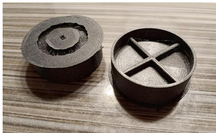
Slika 29. Par običnih kotača neposredno nakon 3D printanja
