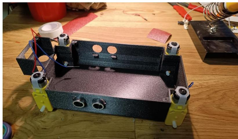
Slika 43. Kućište s postavljenim motorima
