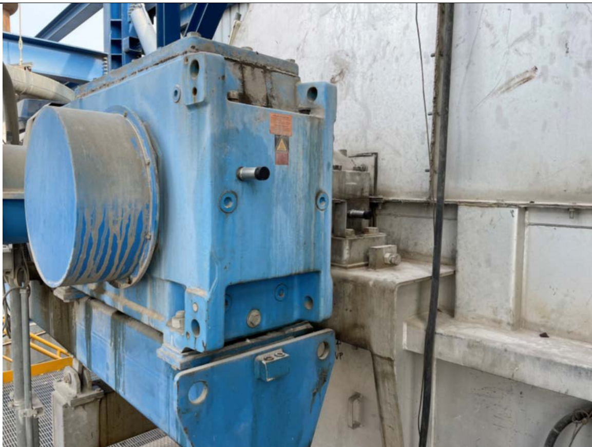
Slika 37. Montirani senzor na reduktoru glavnog pogona peći [11]
