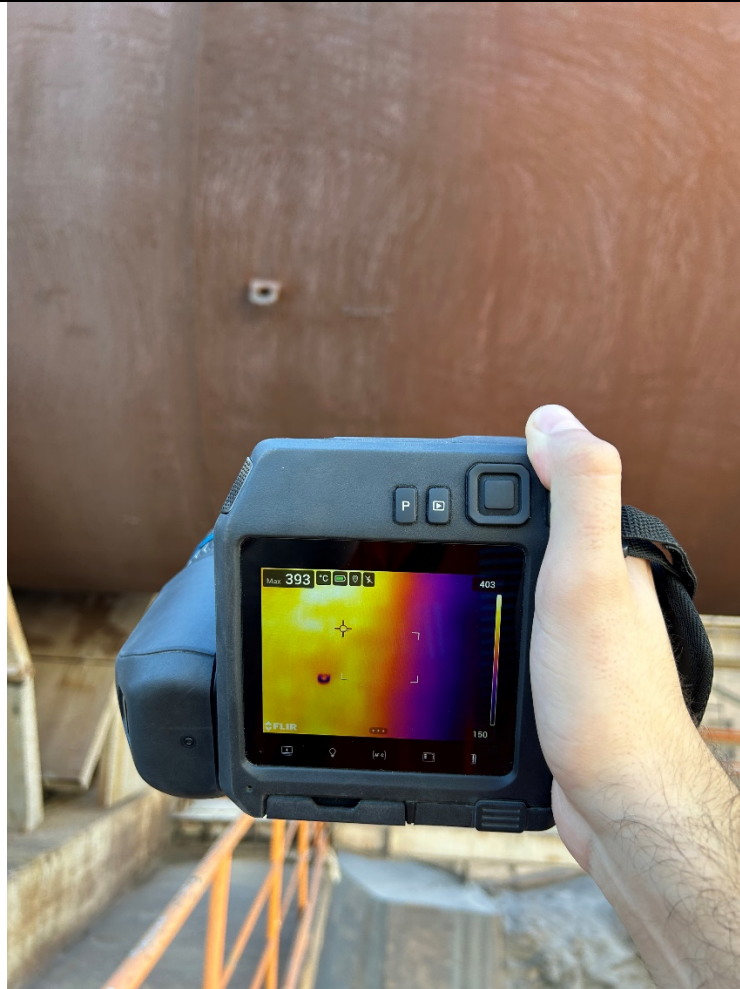
Slika 28. Postupak mjerenja temperature plašta rotirajuće peći
