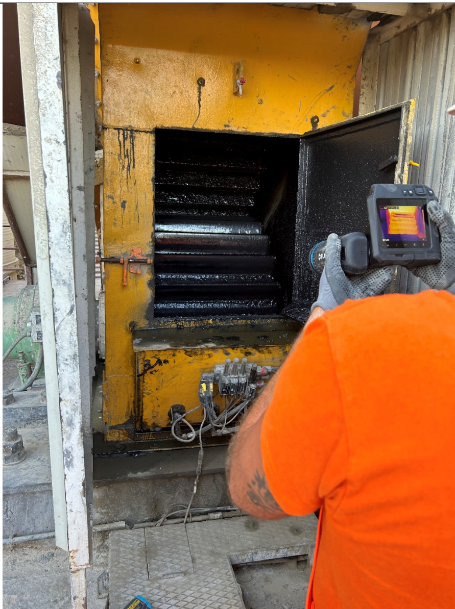
Slika 29. Postupak mjerenja temperature zupčanika rotirajuće peći
