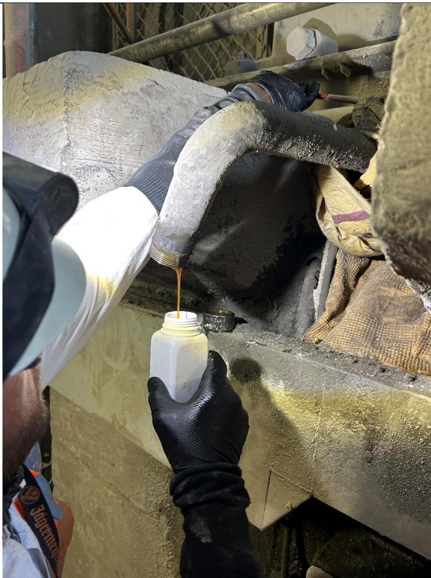
Slika 34. Uzorkovanje ulja s reduktora mlina cementa
