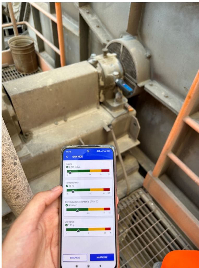
Slika 20. Mjerenje vibracija ležajeva ventilatora otprašivanja peći
