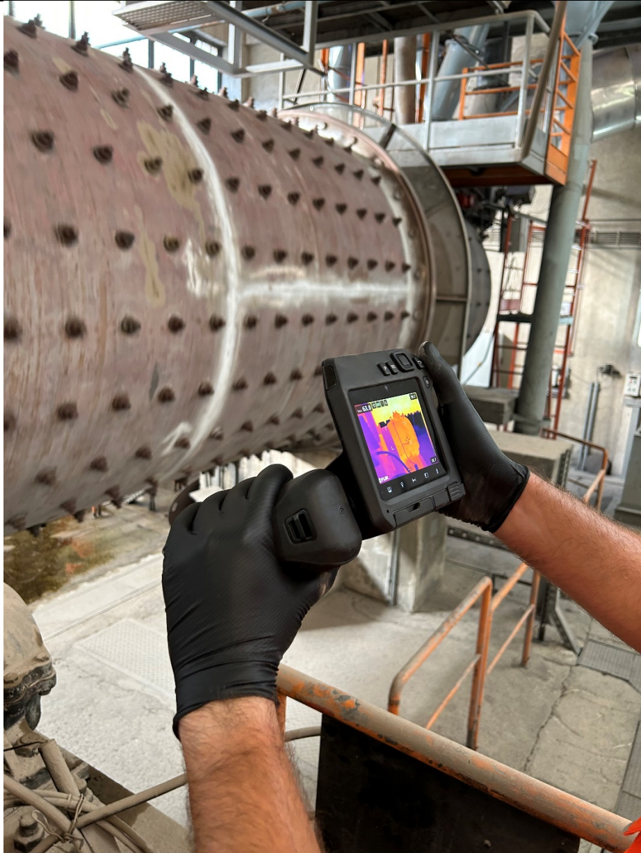
Slika 31. Postupak mjerenja temperature vanjskog ležaja mlina ugljena
