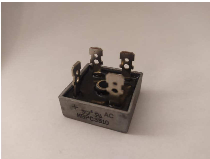
Slika 43. Punovalni ispravljač KBPC3510
