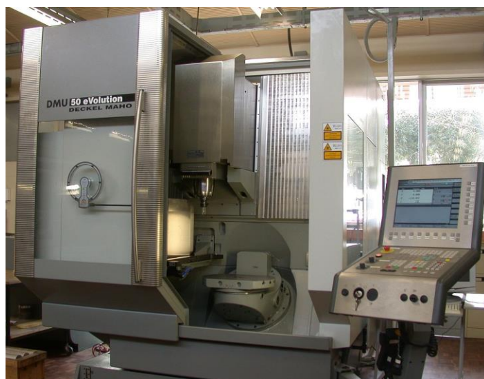
Slika 3. Glodači obradni centar pet-osni [2]
