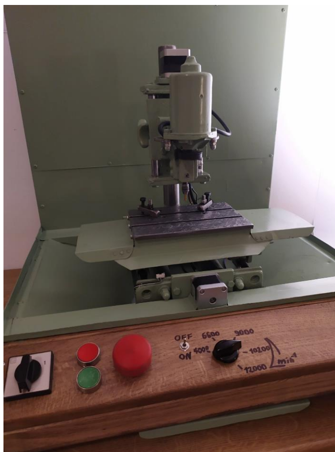
Slika 45. Prikaz kontrolne ploče
