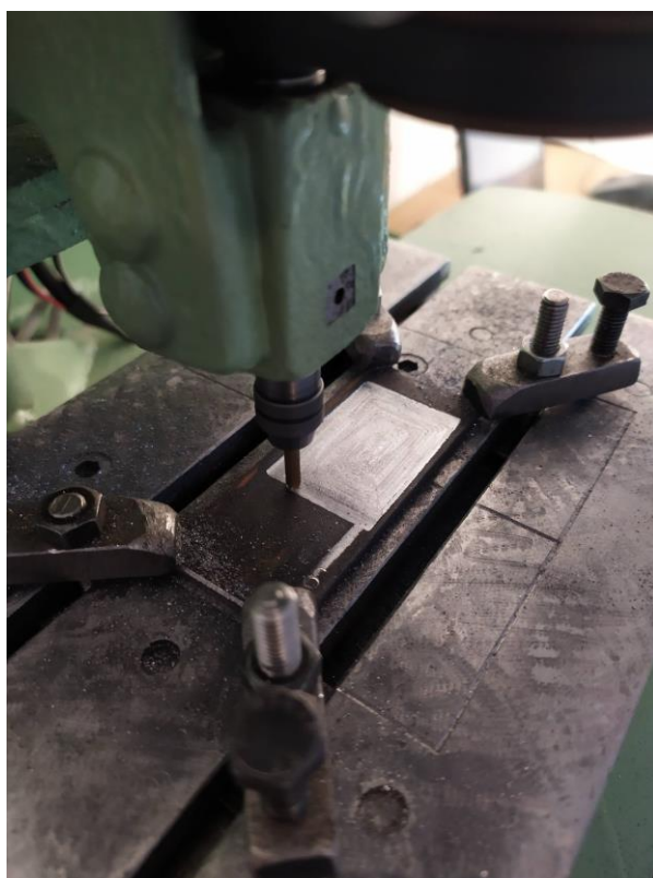
Slika 55. Poravnavanje čeličnog obratka
