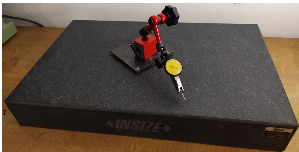
Slika 18. Granitna ploča i mjerna ura
