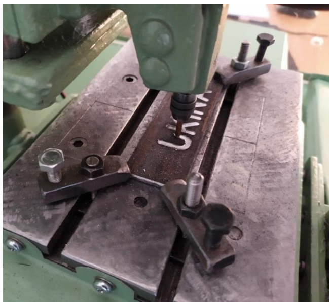
Slika 54. Graviranje čeličnog obratka
