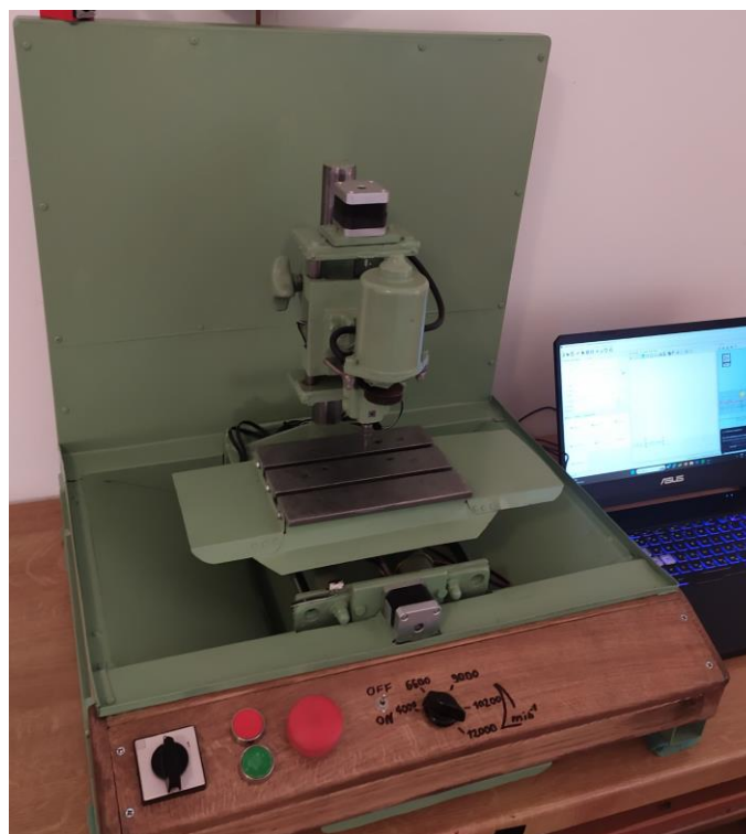
Slika 40. Stvarni izgled sklopa kućišta i glodalice
