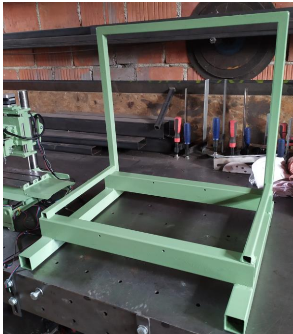
Slika 39. Cijevna zavarena konstrukcija kućišta glodalice
