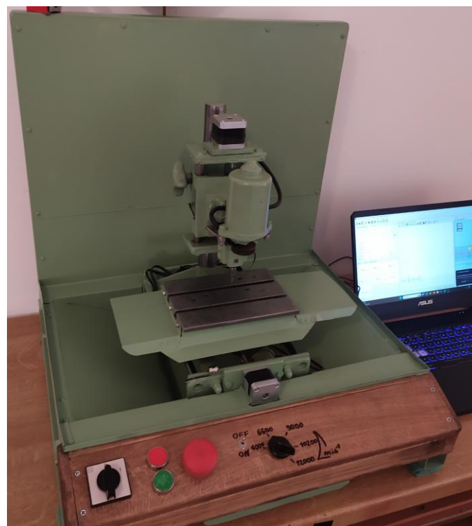
Slika 40. Stvarni izgled sklopa kućišta i glodalice
