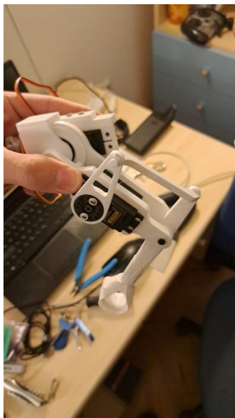
Slika 25. Prototip noge s prevelikim trenjem u području ramena
