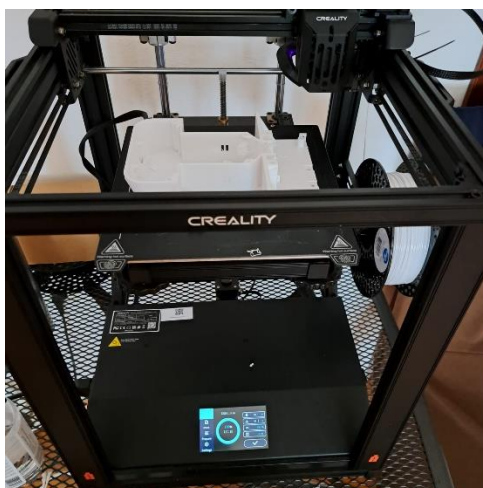
Slika 21. Prednji dio trupa proces izrade
