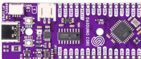
Slika 15. Atmega328P na Dasduino Core pločici
