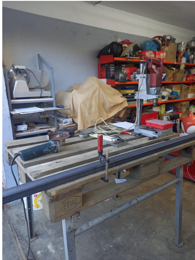
Slika 11. Rezanje i bušenje cijevi
