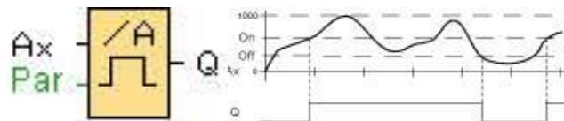
Slika 91. Analog trigger [32]
