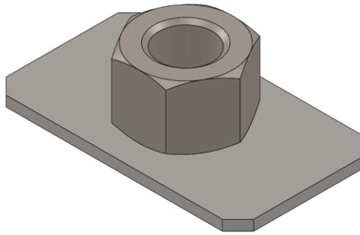
Slika 21. Spoj matice i metalne pločice
