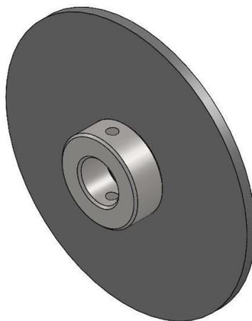
Slika 42. Spoj lančanika i držača za lančanik
