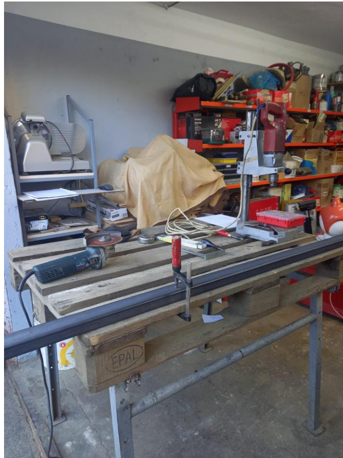
Slika 11. Rezanje i bušenje cijevi
