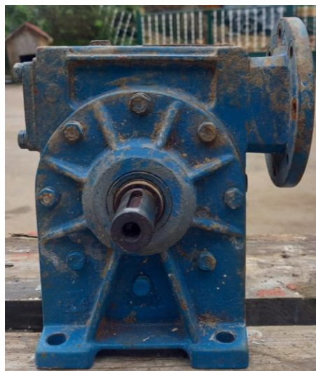
Slika 49. Reduktor za mješać i pužni transporter
