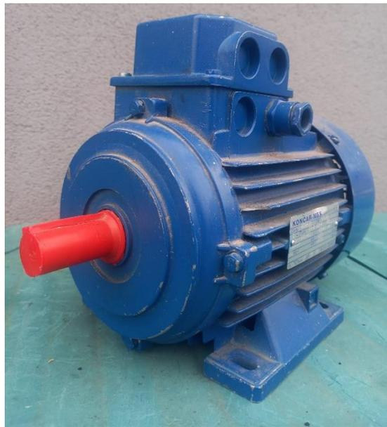
Slika 48. Motor za mješač i pužni transporter
