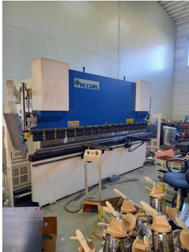
Slika 9. Stroj za savijanje limova
