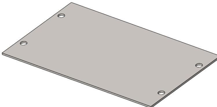
Slika 30. Poklopac kraćeg dodatka na horizontalni kanal
