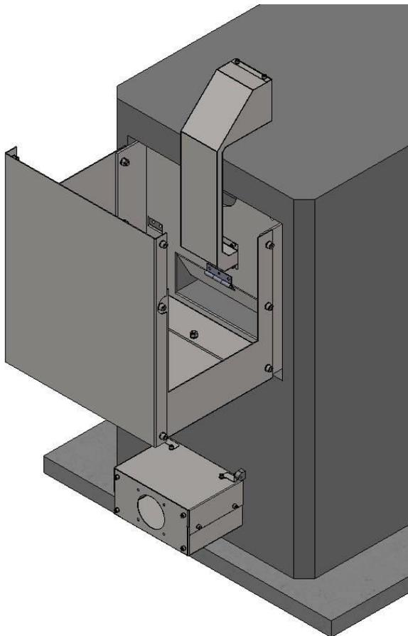
Slika 73. Sklop ventilacije
