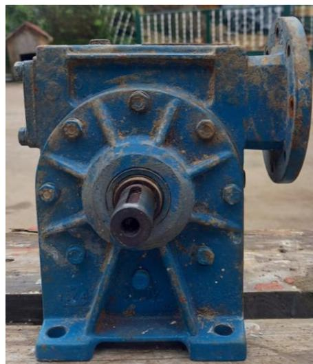
Slika 49. Reduktor za mješač i pužni transporter
