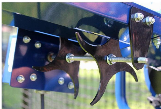
Slika 16. BATA pitching machine auto feeder mehanizam izbacivanja loptica [16]
