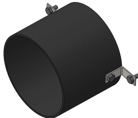
Slika 50. Priključak crijeva na prirubnicu spremnika
