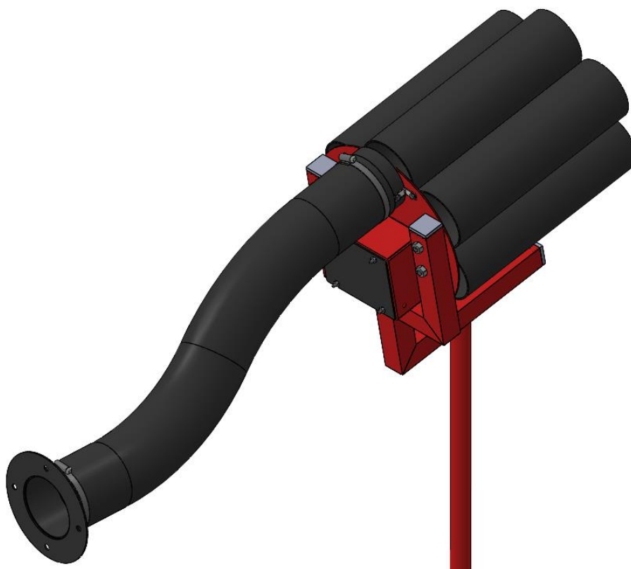
Slika 55. Spremnik optica sa mehanizmom za izbacivanje optica
