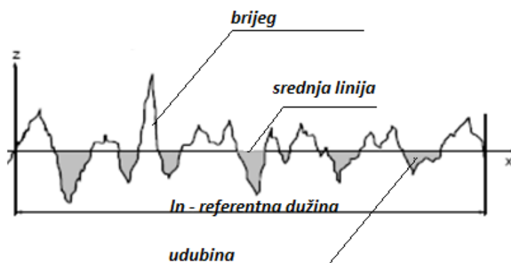
Slika 25. Odrađivanje srednje linije hrapavosti oblika [7]
