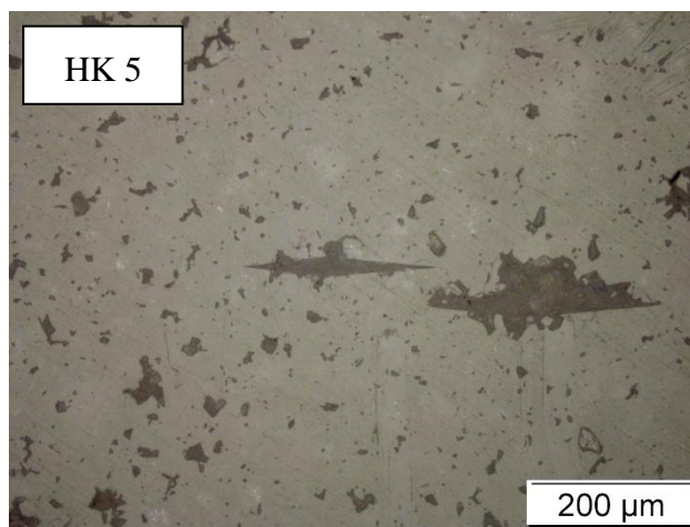
Slika 49. Otisci Knoopovog indentora na površini brušenoj SiC papirom znatosti 4000
